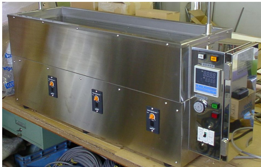
スターラー攪拌式の高精度オイルバス(化学品メーカー)
