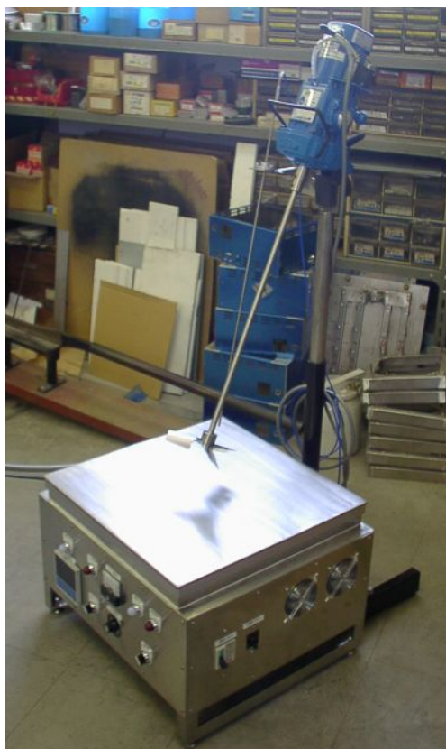
プレート温度を監視しながら試料温度を制御する高温ホットプレート(素材メーカー等)
