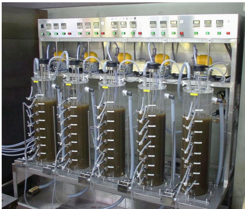
流入・曝気・沈殿・排出の4工程を連続制御(大学工学部)
