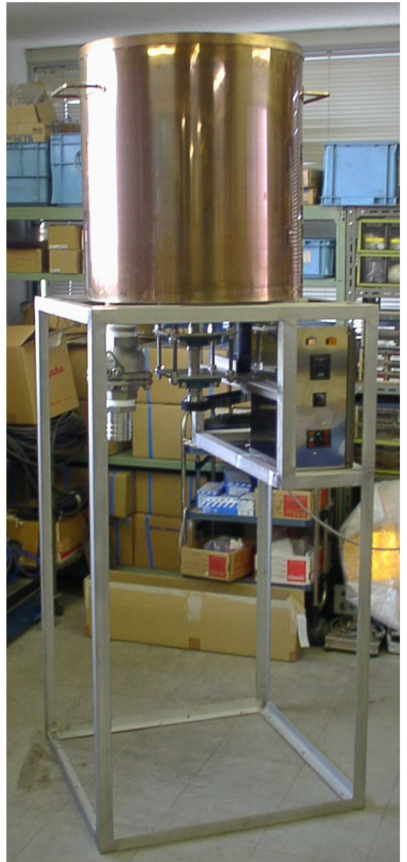
タンク内面をテフロンコーティングし、高分子材料を攪拌する大型タンク(素材メーカー)
