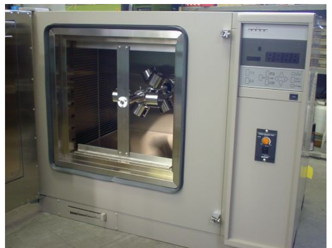
恒温槽内で数種類の圧力容器を回転(大学工学部)
