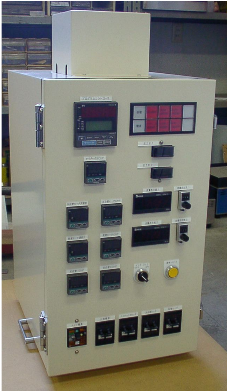
反応管ユニット制御装置(樹脂製造メーカー)
