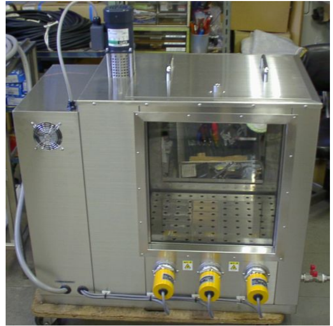
大型観測窓を採用し、水槽内全て目視可能(プラントメーカー)
