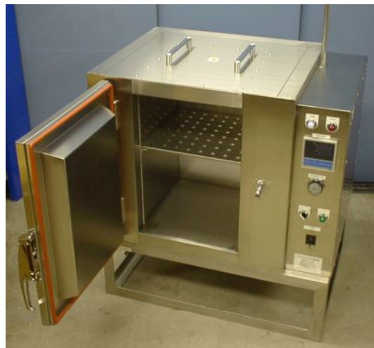
ジャケット内オイルで間接加熱(薬品メーカー)
