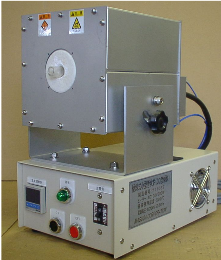
炉自体を30° 傾斜し試験管内試料が安定(塗料メーカー)
