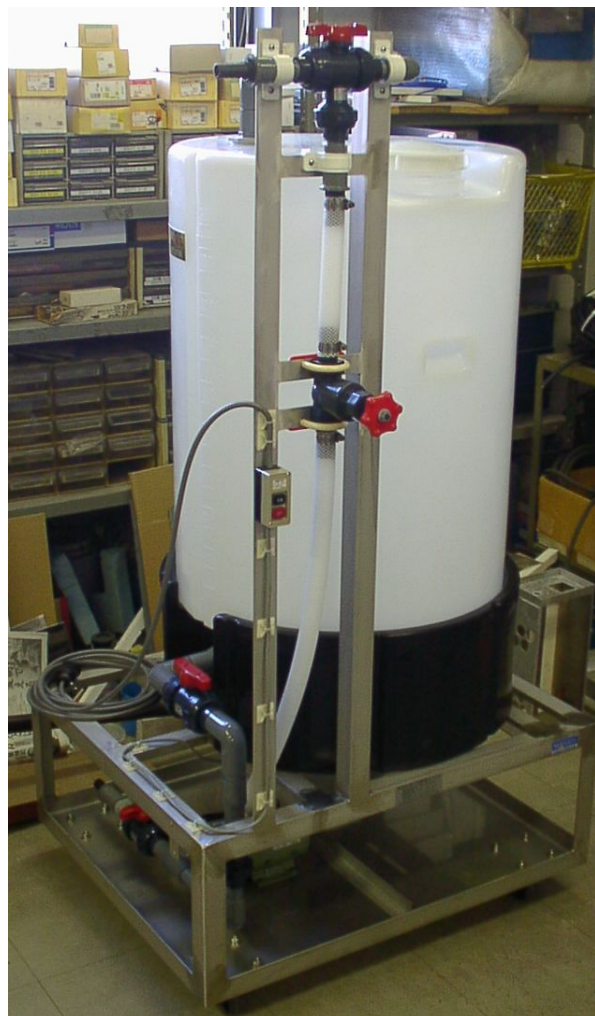
酸性水溶液をバルブ操作で外部循環(素材メーカー)
