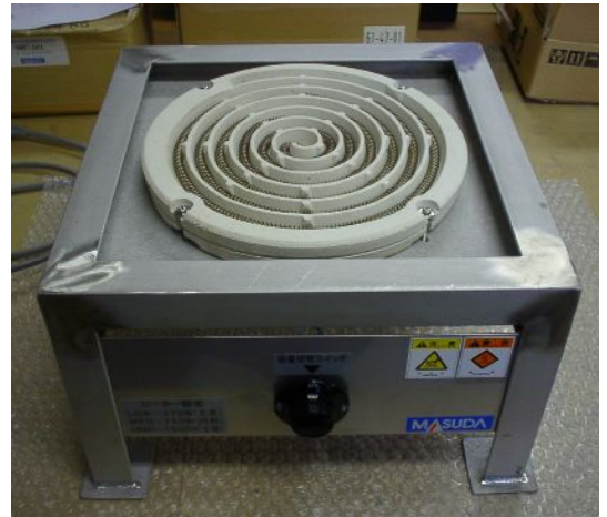
100V3kW(3連式)／1.5kWの電熱器
