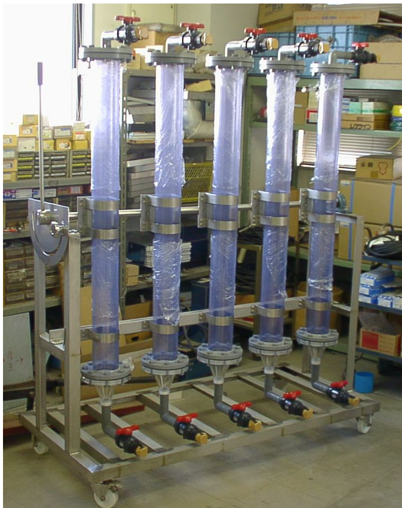
傾斜させ筒内の樹脂を排出・洗浄できるカラム(素材メーカー)
