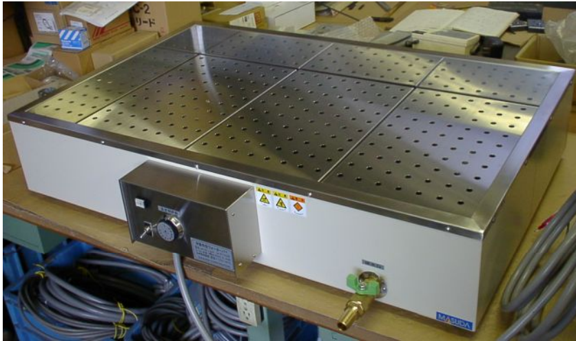
MSD角型ウォーターバスM100シリーズの容量80Lタイプ(半導体メーカー)
