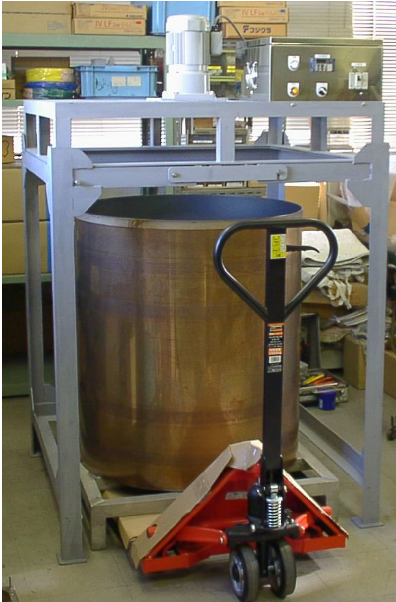
タンク内面をテフロンコーティングし、高分子材料を攪拌する大型タンク(素材メーカー)
