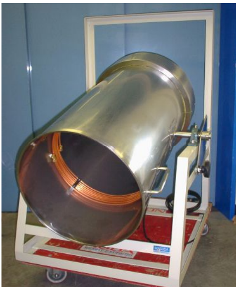
試験片を加熱した溶剤で脱脂洗浄→溶剤ペーパーを冷却し液化→タンク傾斜で溶剤排出(塗料メーカー)
