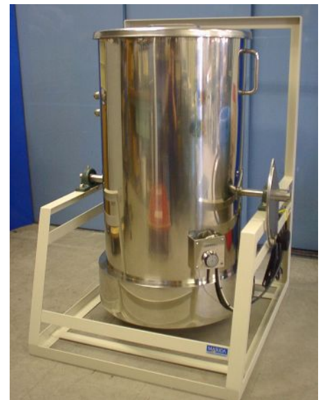
試験片を加熱した溶剤で脱脂洗浄→溶剤ペーパーを冷却し液化→タンク傾斜で溶剤排出(塗料メーカー)
