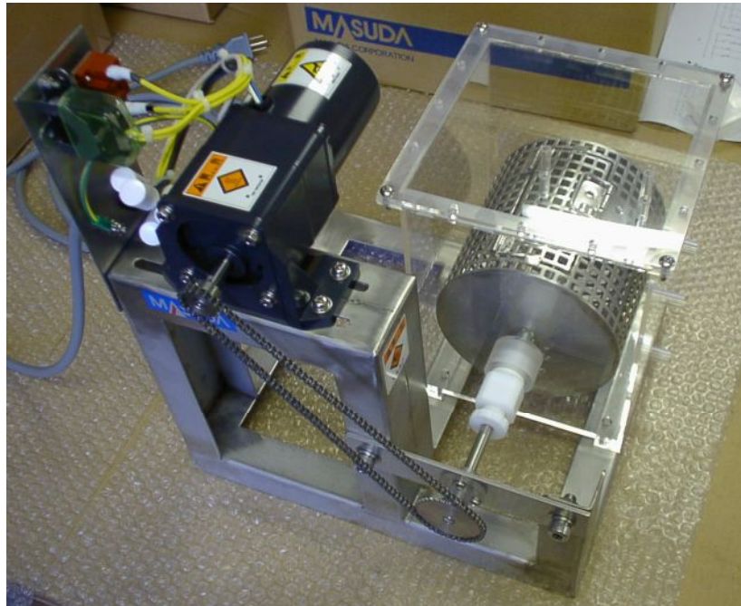
ステンレス製ドラムを溶液内で回転(医薬品メーカー)
