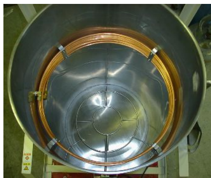
試験片を加熱した溶剤で脱脂洗浄→溶剤ペーパーを冷却し液化→タンク傾斜で溶剤排出(塗料メーカー)
