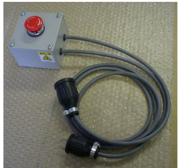
ボタン押下で装置電源遮断
